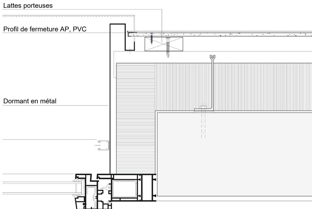
Le raccordement du châssis de fenêtre avec le composant voisin doit être étanche côté chaud. (Norme SIA 331 fenêtres)
