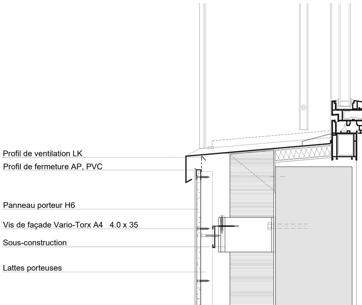
Le raccordement du châssis de fenêtre avec le composant voisin doit être étanche côté chaud. (Norme SIA 331 fenêtres)
